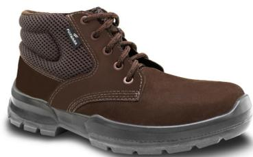
Calçado ocupacional de uso profissional, tipo botina, fechamento em amarrar, confeccionado em nubuck, palmilha de montagem em material sintético montada pelo sistema strobel, biqueira de conformação, solado de poliuretano bidensidade com propriedade antiderrapante injetado diretamente no cabedal, com sistema de absorção de energia na região do salto, resistente ao óleo combustível.
