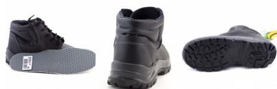
Botina de segurança de amarrar, cano acolchoado, confeccionada em couro lixado, com forração interna na gáspea em não tecido, forro do cano em nylon dublado com manta de não tecido com tratamento antimicrobiano, com biqueira plástica sem componentes metálicos, palmilha em EVA e solado de poliuretano injeção direta bidensidade bicolor.
