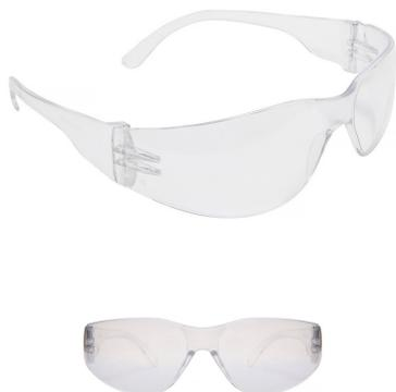
Óculos de segurança constituídos de armação e visor confeccionados em uma única peça de policarbonato incolor, lente com proteção contra raios ultravioleta (U6) com apoio nasal injetado do mesmo material. As hastes, do tipo espátula, são confeccionadas do mesmo material da armação, e são fixas através de parafuso metálico.
