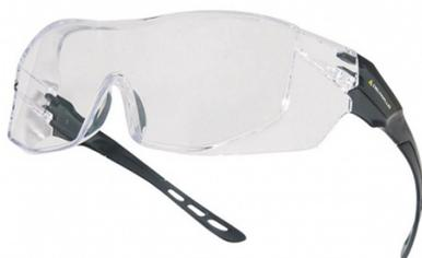
Óculos de segurança, constituídos de armação e visor confeccionados em uma única peça de policarbonato incolor com proteção em toda a extensão da borda superior e na lateral e hastes tipo espátula. As hastes são confeccionadas de material plástico preto e são fixas à armação através de pinos plásticos.
