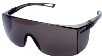
Óculos de segurança, constituídos de armação e visor confeccionados em uma única peça de policarbonato cinza (fumê), com apoio nasal e proteção lateral injetados do mesmo material. As hastes, do tipo espátula com orifício nas pontas para colocação de cordão., são confeccionadas do mesmo material da armação e fixas às extremidades do visor através de pinos plásticos. Ideal para uso em serviços de eletricidade.
