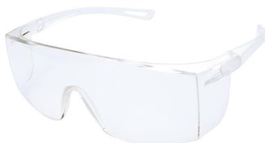
Óculos de segurança, constituídos de armação e visor confeccionados em uma única peça de policarbonato incolor, com apoio nasal e proteção lateral injetados do mesmo material. As hastes, do tipo espátula com orifício nas pontas para colocação de cordão., são confeccionadas do mesmo material da armação e fixas às extremidades do visor através de pinos plásticos. Ideal para uso em serviços de eletricidade.
