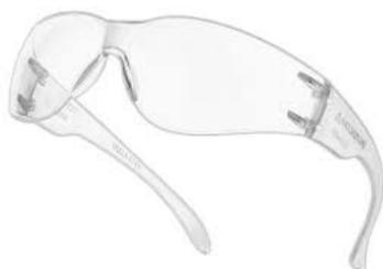
Óculos de segurança, constituídos de armação e visor confeccionados em uma única peça de policarbonato incolor, com ponte e apoio nasal injetados do mesmo material. As hastes, do tipo espátula, são confeccionadas do mesmo material da armação e fixas às extremidades do visor através de parafusos metálicos.
